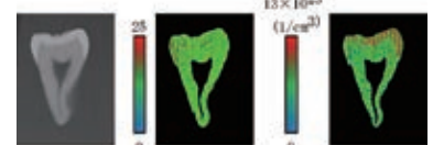
▲現在開発中の半導体型検出器を用いたエックス線撮影により、物質の実効原子番号や電子密度が分かれます。単純X線画像(左)、実効原子番号のカラー画像(中央)、電子密度のカラー画像(右)。
