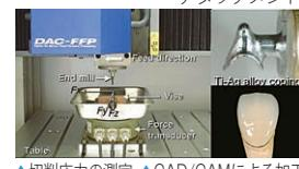
▲切削応力の測定 ▲CAD/CAMによる加工
